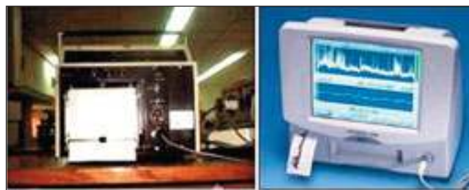
Obr. 1: Typy aEEG monitorů: analogový přístroj (Lectromed), digitální monitor (CFM 6000)
